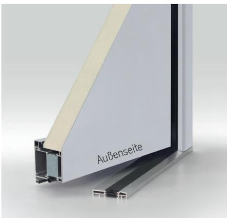
flächenversetztes Aluminium-System mit 90 mm Bautiefe und einseitig flügelüberdeckender Füllung (Stärke 66 mm)
